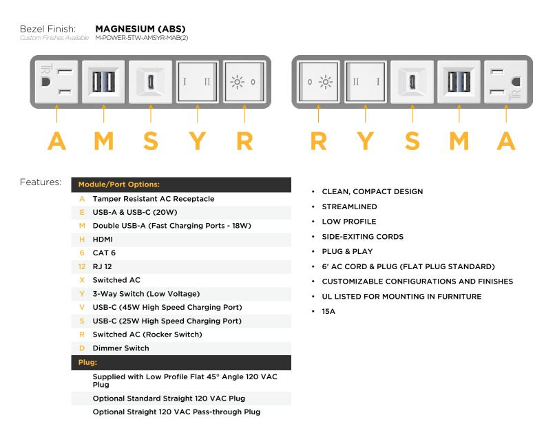
UL LISTED AND APPROVED FOR USE ONLY WITH METRO LIGHT & POWER'S UL LISTED LEDS & CLASS 2 UL LISTED LED DRIVERS
