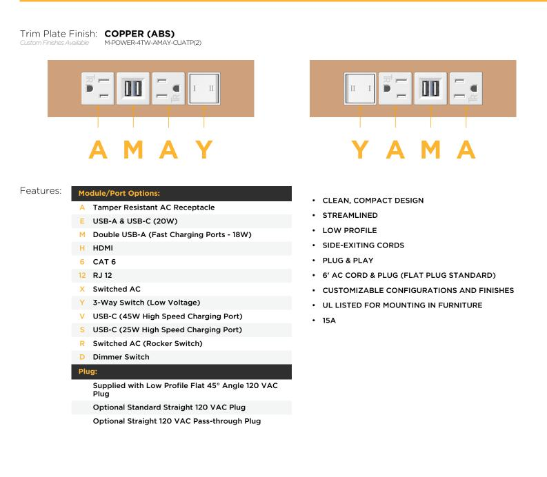
🕂 UL LISTED AND APPROVED FOR USE ONLY WITH METRO LIGHT & POWER'S UL LISTED LEDS & CLASS 2 UL LISTED LED DRIVERS
